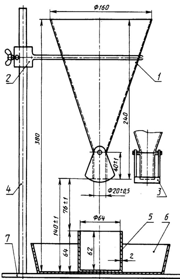
1 — воронка; 2 — устройство для установки воронки по высоте; 3 — выпускной клапан (закрытый);
